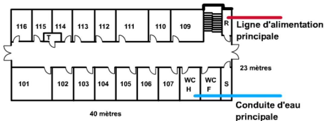
L'immeuble ouest est situé à 17 m environ de l'immeuble principal. Ses dimensions sont de 40 m x 37 m. Une étude préliminaire de l'immeuble a permis d'identifier trois emplacements possibles pour des locaux techniques au premier étage. Ils sont indiqués par les lettres R, S et T sur le plan d'étage.
