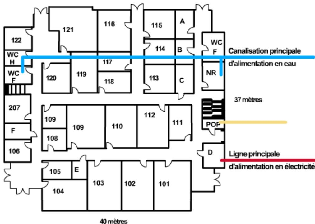
L'immeuble principal mesure 40 m x 37 m environ. Après une étude préliminaire effectuée sur l'immeuble, six emplacements possibles pour les locaux techniques ont été déterminés au premier étage. Sur le plan de l'immeuble, ces emplacements sont désignés par les lettres A, B, C, D, E et F.
